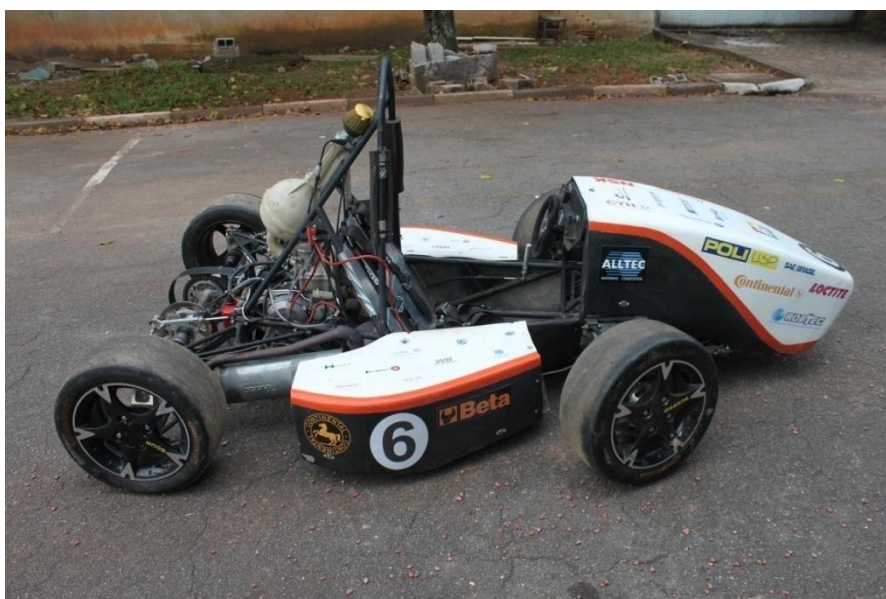
Figura 4. Foto do sistema de exaustão atual do FP02-MA
