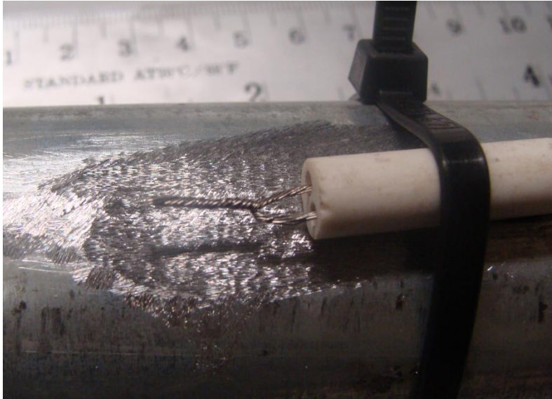
Figura 23. Detalhe do enrolamento do termopar
